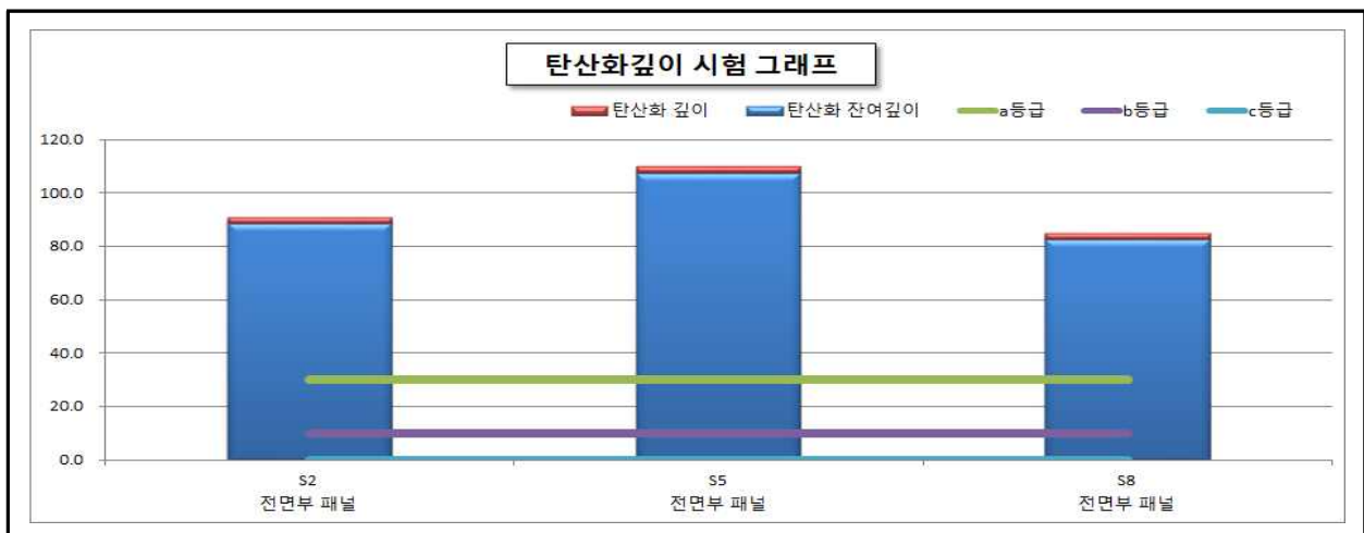
【그림 71.8】 탄산화 깊이 측정결과
